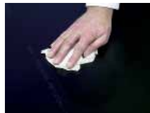
Voorbehandeling achterzijde met Easy Clean Wipes of Primer PanelTack
